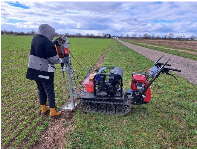
Rasterartige Beprobung der gravimetrischen Bodenfeuchte im Projektgebiet (LTZ)
