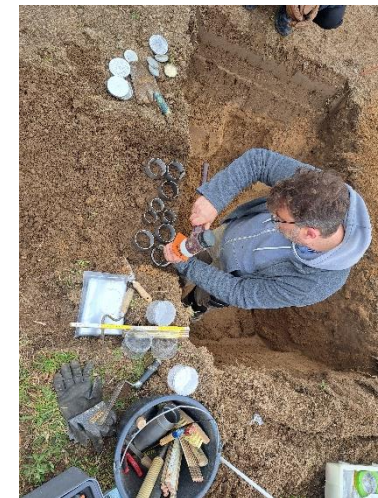
Bestimmung der hydraulischen Leitfähigkeit an ausgewählten Stellen (LTZ)
