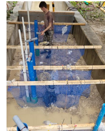
Aufbau des in-situ Versuchs in einem künstlichen porösen Aquifer in Obernach (D)
